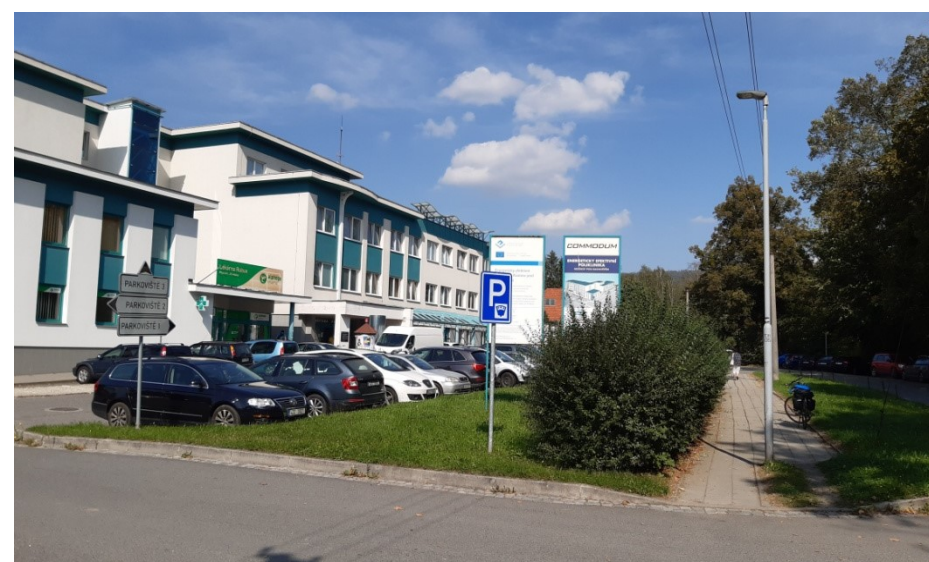
Ul. Letenská – lampa veřejného osvětlení uprostřed chodníku před poliklinikou komplikuje průchodnost chodníku (nejen) pro vozičkáře
